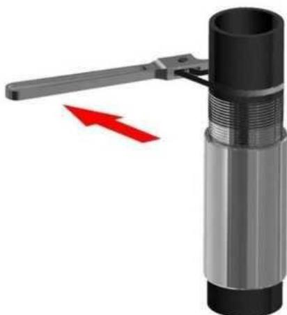
Рисунок 12- Начало свинчивания с использованием ленточного ключа
