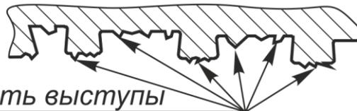
б) – Поверхность резьбового соединения муфты
