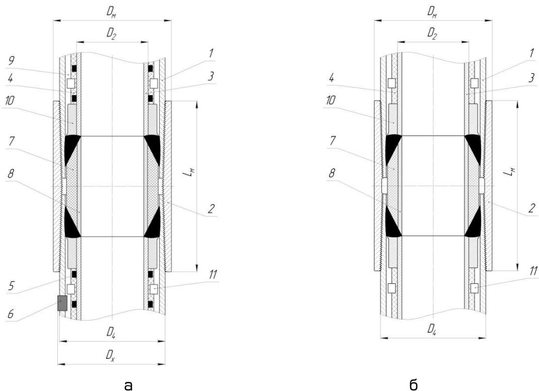
1 – труба внешняя несущая; 2 – муфта; 3 – внутренняя труба; 4 – экранная изоляция; 5 – геттер (поглотитель остаточных газов); 6 – клапан вакуумный; 7 – вкладыш муфтовый; 8 – втулка защитная металлическая; 9 – вакуумированное межтрубное пространство; 10 – элемент соединительный; 11 – центратор.
