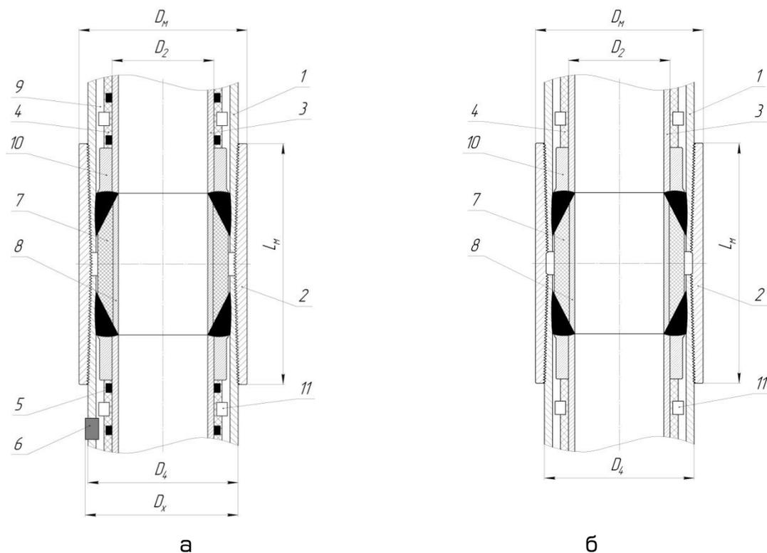
1 – труба внешняя несущая; 2 – муфта; 3 – внутренняя труба; 4 – экранная изоляция; 5 – геттер (поглотитель остаточных газов); 6 – клапан вакуумный; 7 – вкладыш муфтовый; 8 – втулка защитная металлическая; 9 – вакуумированное межтрубное пространство; 10 – элемент соединительный; 11 – центратор.
