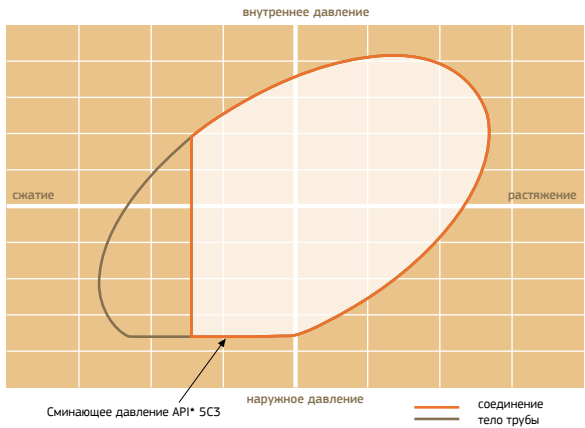
Диаграмма прочностных характеристик обсадных труб с резьбовым соединением TMK UP MAGNA
